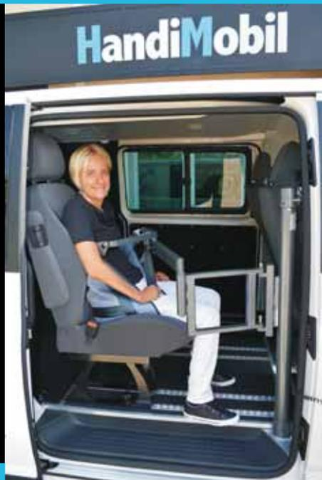
Pour accéder aux véhicules hauts, le «KPPL 100» représente une aide au transfert de la personne idéale. Idéale car l'utilisateur à mobilité réduite voyagera assis confortablement dans un siège d'origine. Idéale car elle évite toute modification structurelle lourde et coûteuse du véhicule.
