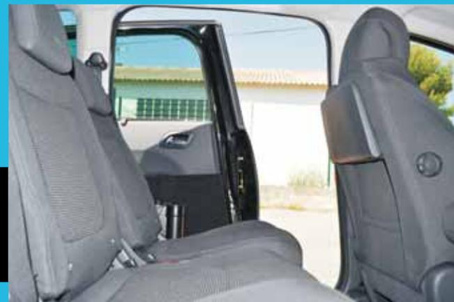
La porte escamotable libère un espace suffisant pour glisser un fauteuil roulant manuel plié. S'associe aux systèmes de treuil ou de robot de chargement. Fonctionnant par télécommande filaire, elle dispose d'une sécurité interdisant son ouverture pendant la conduite.
