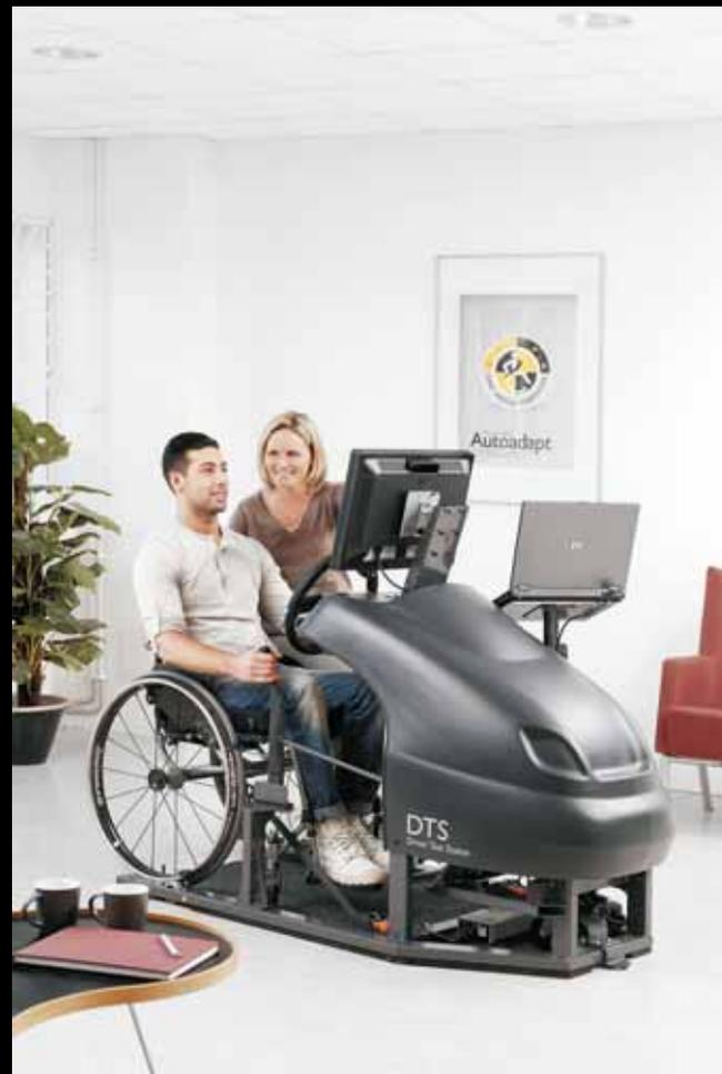
La « DTS » - « Driver Test Station »- n'est pas un simulateur mais bel et bien un outil de mesure et d'analyse des aptitudes physiques du conducteur. Vous pouvez, au travers de tests qualifiés, y évaluer vos compétences lors d'exercices élémentaires comme l'accélération, le freinage ou encore différentes manœuvres. Vous confirmerez votre capacité à conduire en toute sécurité.
