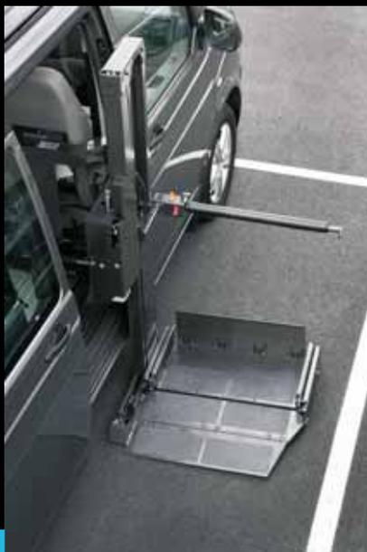
La plate-forme élévatrice Swing-A-Way permet à l'utilisateur de se transférer dans son véhicule, avec son fauteuil roulant, par la porte latérale. Elle est unique de par sa conception puisqu'elle est la seule à opérer le transfert de la personne par un mouvement rotatif. La personne avec son fauteuil se présente sur la plate-forme parallèlement au véhicule et non face à lui.
