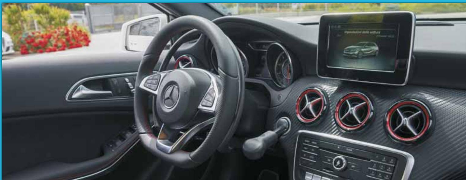
K5: Discret et pratique, il permet au conducteur d'adapter sa conduite au type de parcours emprunté, grâce à son double sens d'accélération, « en tirant » ou « en poussant ».
