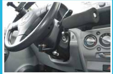
Le CT 08 est un combiné accélérateur / frein appelé communément «Tirer-Pousser». Il peut être électrique ou mécanique. On tire le levier pour accélérer, ou le pousse pour freiner. Le choix de la poignée, le placement du combiné, l'ergonomie générale sont considérés avec le conducteur.
