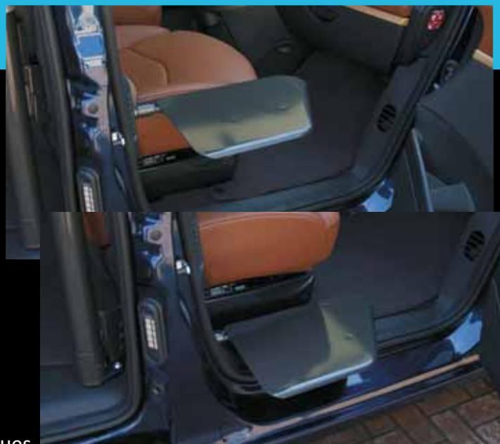
Le plateau de transfert à montée et descente électriques facilite l'accès à tout véhicule dont la hauteur de siège est différente de celle du fauteuil roulant. Il est releable et amovible. Capacité de levage maximum : 120 kg
