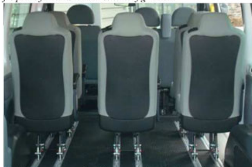
Rails communs pour les sièges amovibles et les fauteuils roulants permettant une grande convertibilité
