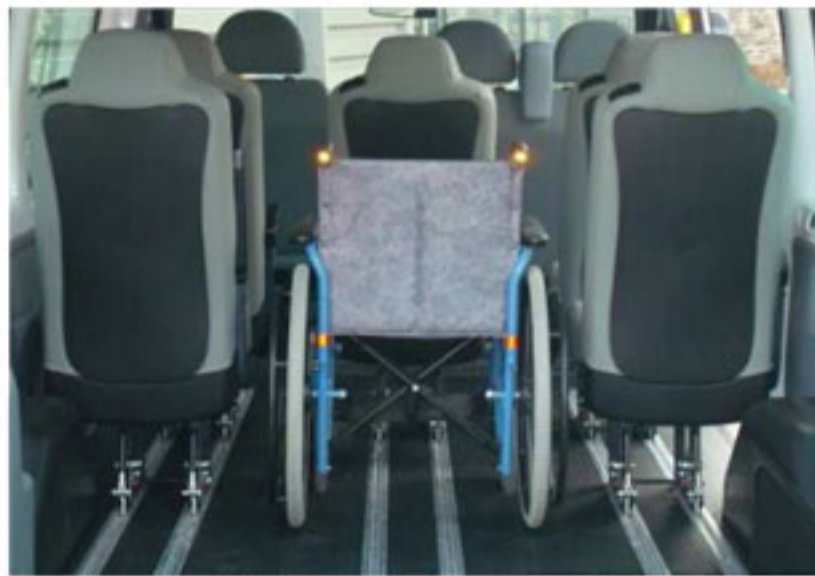
Rails communs pour les sièges amovibles et les fauteuils roulants permettant une grande convertibilité
